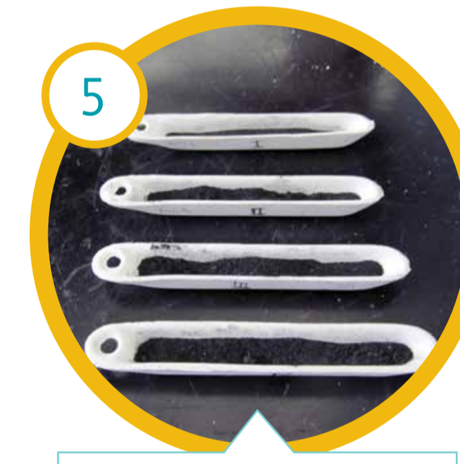
5 Fijación del manganeso en el carbón activado
