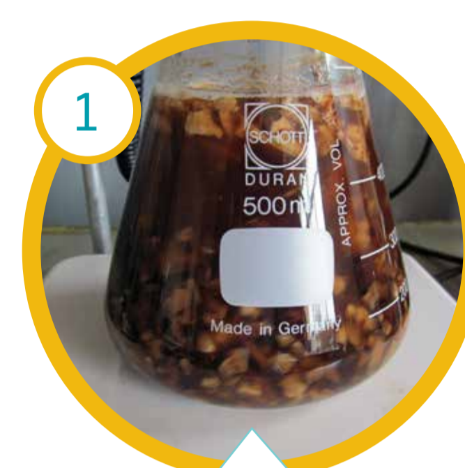
1 Impregnación de semillas de aguaje con ácido fosfórico
